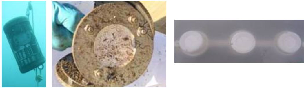
Photo 2. Echantillonneur passif de type POCIS en suspension dans la colonne d'eau (gauche), détail d'un POCIS après 20 jours d'immersion (centre), Echantillonneurs passifs de type DGT (droite).
