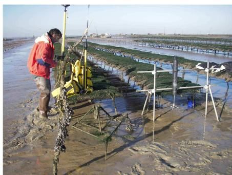
Figure III-12 : Courantomètre ADV géopositionné par DGPS, sur sa structure en aluminium, sur le banc de Lamouroux, en novembre 2007. (Photographie : S.Kervella)
