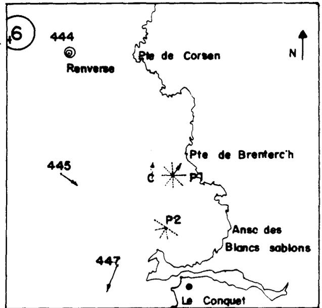
Les mesures aux stations P1 et P2 ont été faites durant une marée (Coef.88, vent NE faible) sur toute la tranche d'eau. A la station C, (profondeur 13m.) un enregistrement a été effectué durant 14 jours à 11 m. du fond par des coefficients de 60 à 90. Les vitesses et les directions varient peu avec les coefficients.
