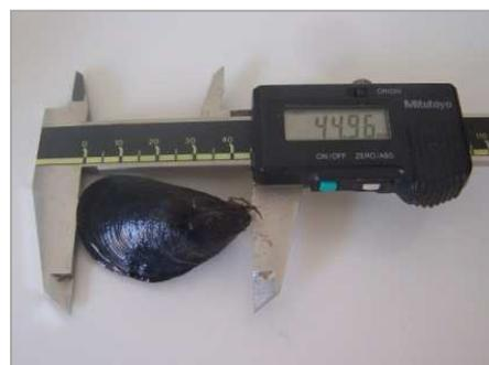
**Photographie 15. Mesure d'une moule avec un pied à coulisse**
