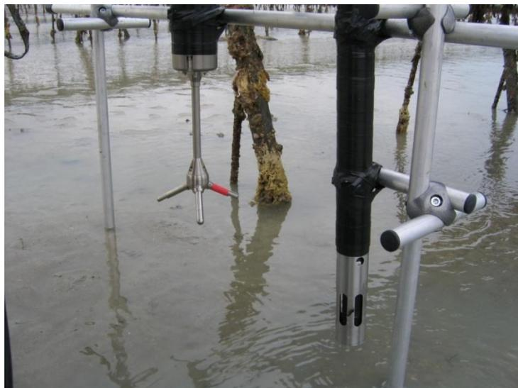
*Figure IV.1: turbidimètre situé sous une table à huîtres en baie du mont Saint-Michel (à droite de l'image)*
