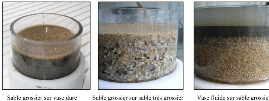
Figure 5 : Exemples d'interfaces reconstituées et testées en laboratoire avec ALTUS
