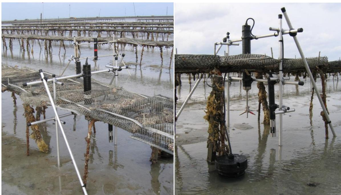
*Figure III.2: A gauche : vue d'ensemble de l'ADV A1 (au premier plan, mesure sous la table) et de l'ADV A2 (au second plan, mesure dans l'allée). A droite : ADV A1 avec son bloc batterie supplémentaire au niveau du sol.*
