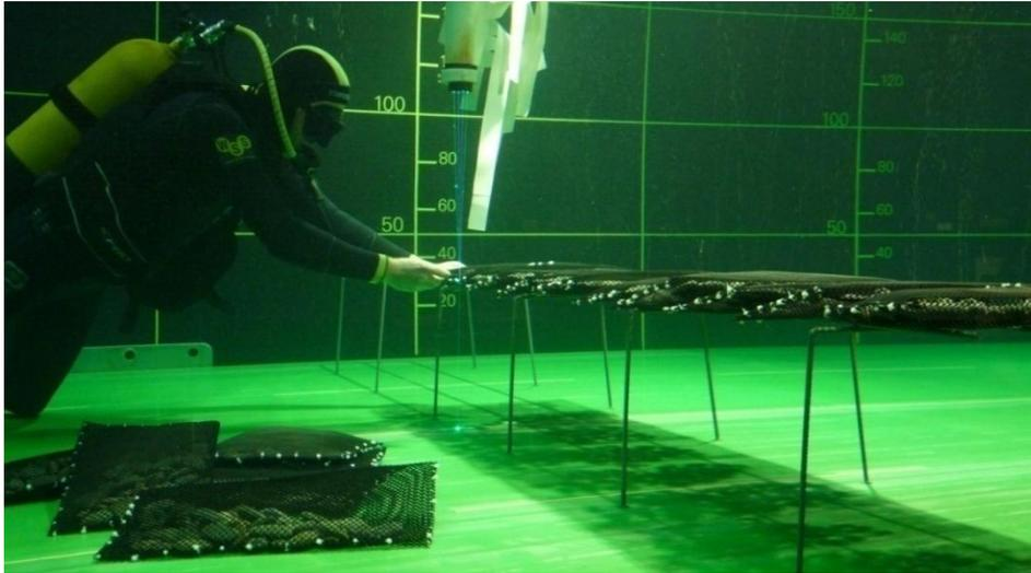
Figure III.15: Placement des poches dans la configuration C (alignement au laser).
