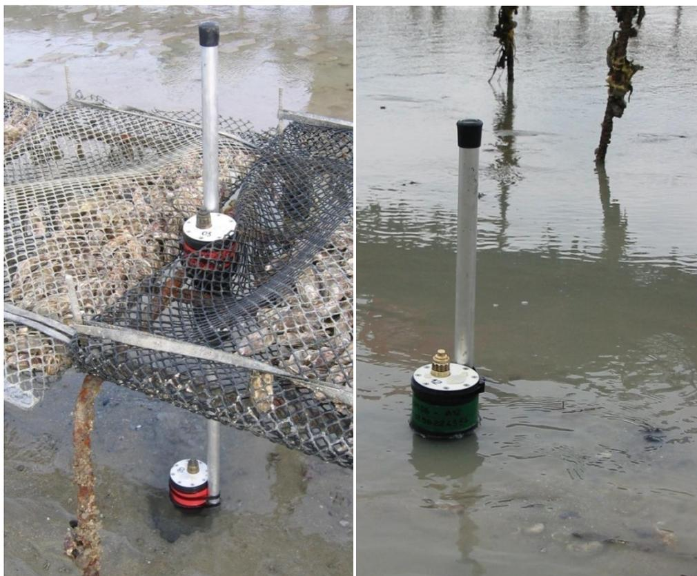
Figure II.6: capteurs de pression ALTUS P1 et P2 à gauche, capteur de pression P6 à droite.
