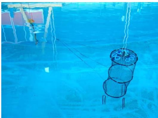
Photo 21 : Nasse cylindrique flottante verticale à deux chambres
