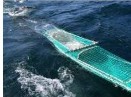
Photo 13 : Manœuvre du kit grille et PMC merlu
