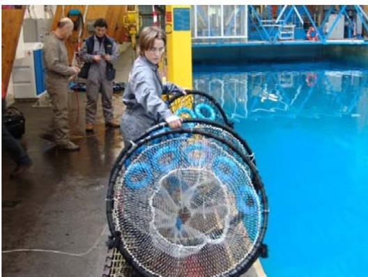
Photo 19 : Nasse cylindrique flottante horizontale à deux chambres
