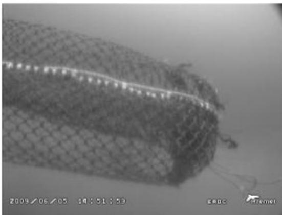
Photo 29 : Vue sous-marine du concept de cul de chalut en T90
