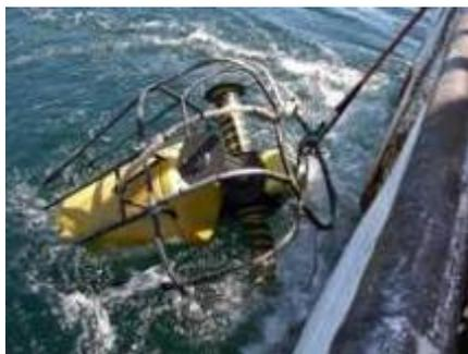
Photo 10: Mise à l'eau du système vidéo EROCC
