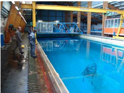
Photo 17 : Nasse rectangulaire flottante à deux chambres
