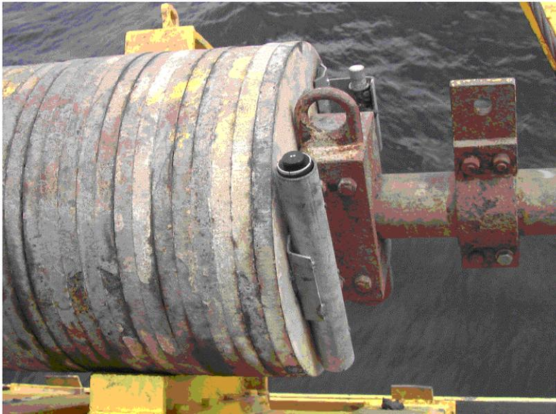
Fig. 4 : Le capteur autonome tel qu'utilisé est placé dans un tube soudé sur le lest d'un carottier « Kullenberg » à bord de l'Atalante. Son encombrement et mode de fonctionnement (rétrodiffusion) permettent de l'installer sur de nombreux types de vecteurs océanographiques (Carottier, piège à particule, engin tracté, robot télé opéré, submersible)
