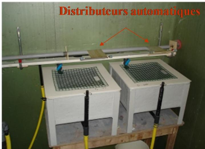
Figure 61 – Système d'exposition de soles utilisé au cours de la phase B.
