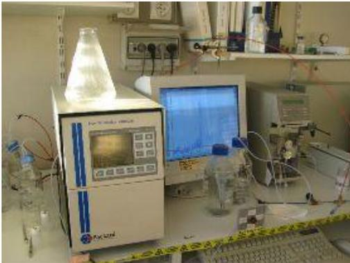
Figure 20 – Système de Radio-HPLC de l'UMR xénobiotiques de l'INRA
