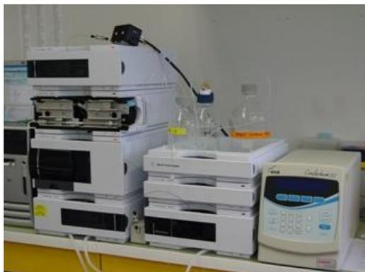
Figure 36 – Système HPLC couplé à un détecteur UV et un détecteur électrochimique.
