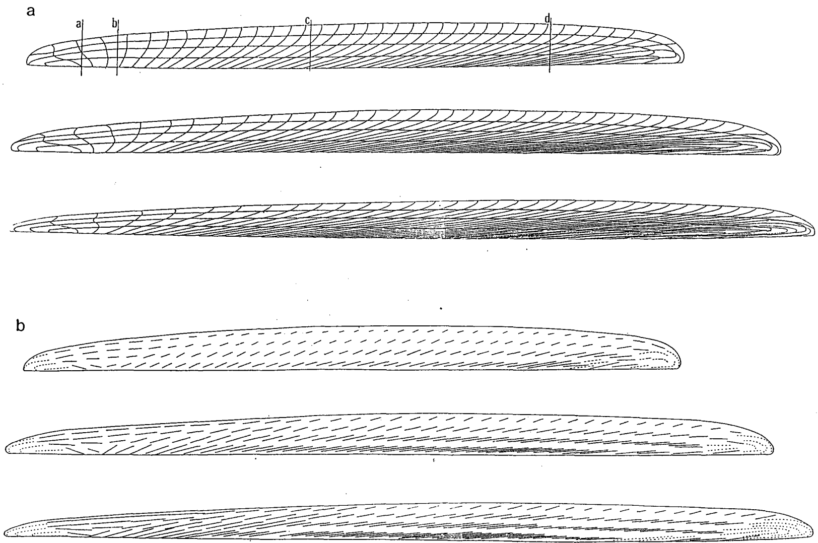
Figure IV.5: Modèles de glissement-étalement de nappes ductiles: champ de déformation dans le plan vertical, parallèle à la direction de déplacement. A: grilles déformées pour trois stades de l'expérience, B: orientation de l'étirement principal (Brun et Merle, 1985).
