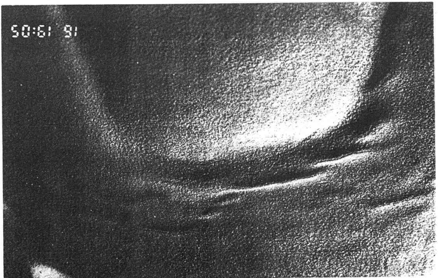
Figure IV.20: Modèle 7 (MAD V.1): A. vue de surface en fin d'expérience. B. Détail de la répartition des rides de silicone au front du talus progradant.
