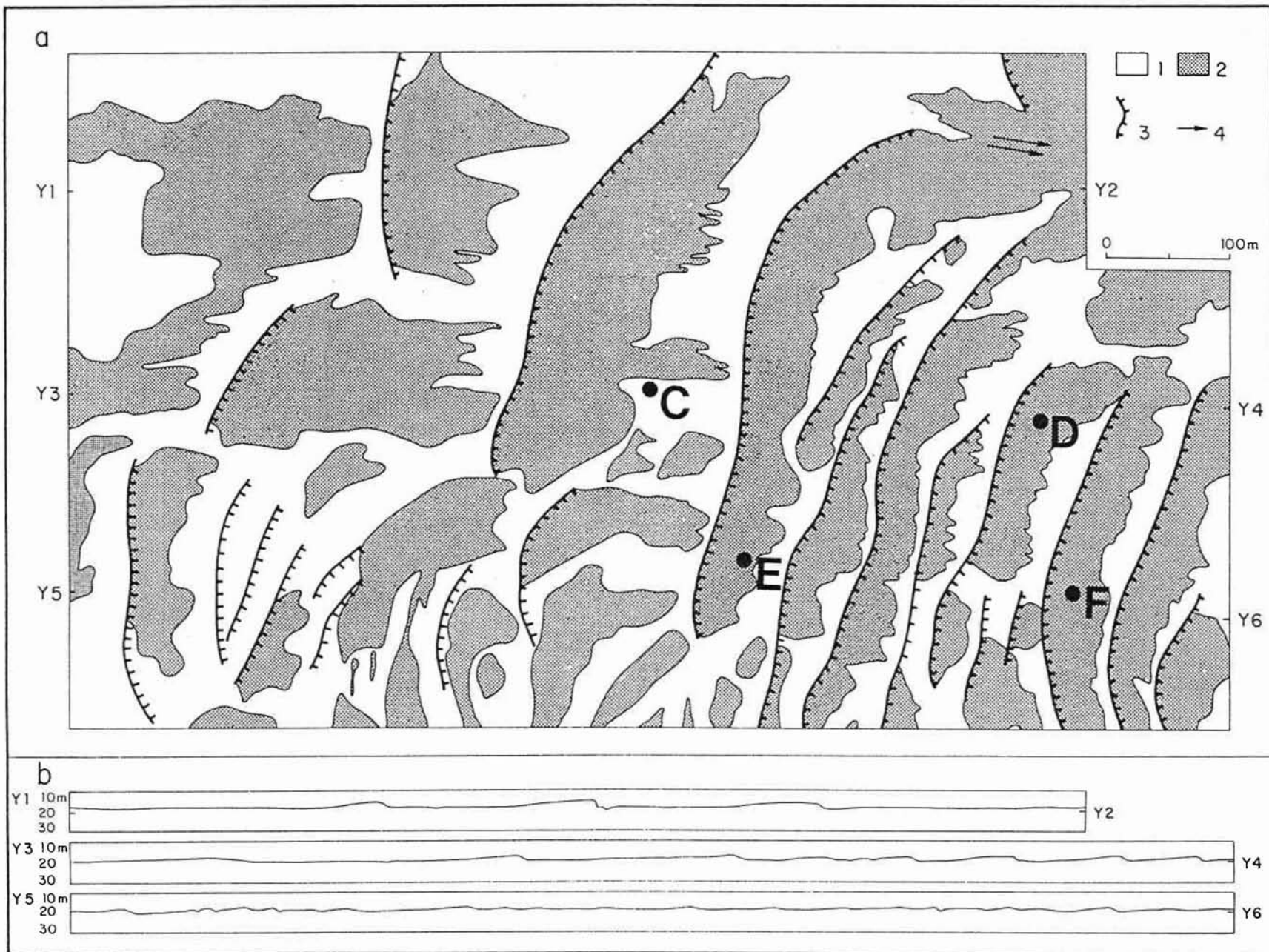
Figure 3B-9-2 : Interprétation de la mosaïque et profils bathymétriques. 1 : sable moyen, 2 : sédiment grossier, 3 : crête dunaire, 4 : ruban sableux ou "queue de comète").
