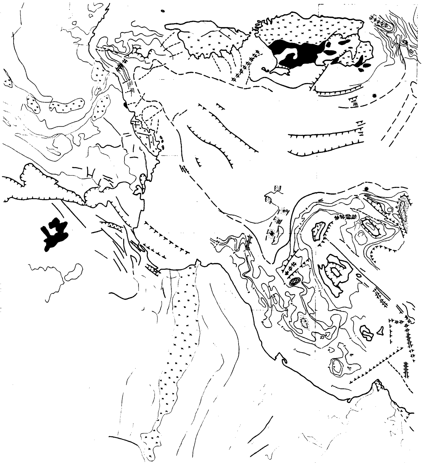
Fig. 29 a et b. Schéma structural des bassins Provençal (29a) et Nord-africain (29b) sur lequel sont figurés : les limites continent-océan supposées ; les alignements volcaniques ; les accidents remarquables et les isochrones du socle acoustique.
