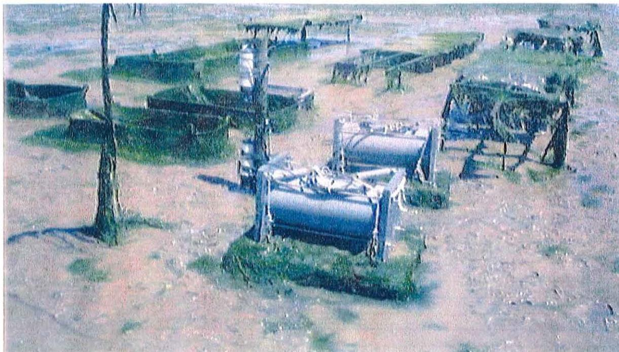
**Figure 4 c :** Sondes hydrologiques placées à l'interface eau-sédiment et à 50 cm du sol ; caissons en PVC contenant le boîtier d'acquisition et la batterie d'alimentation.
