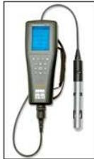
Figure 4 : Sonde multiparamètre « YSI professional Plus » utilisée lors de cette campagne. La mesure de température est réalisée avec une résolution de 0,1 °C, et une précision  $\pm 0,2^\circ\text{C}$ . Le calcul de la salinité est intégré à l'électronique de l'appareil à partir des valeurs de conductivité et de température. La mesure de salinité est réalisée avec une résolution de 0,01 ppt, et une précision  $\pm 0,1$  ppt soit  $\pm 1\%$ .
