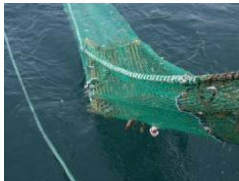
photo 9 : mise en œuvre du kit grille depuis le chalutier
