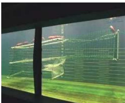
photo 14 : déformation de l'avant de la nasse placée dans un courant d'eau
