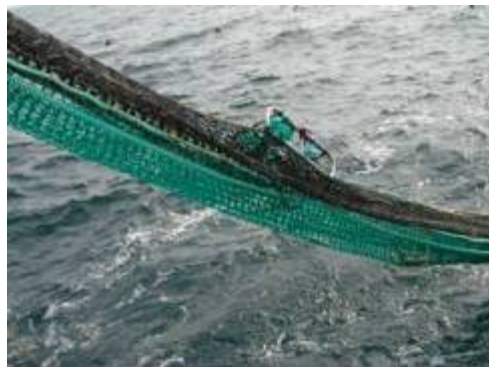
photo 11 : Caméra VECOC au-dessus du panneau à maille carrée langoustine
