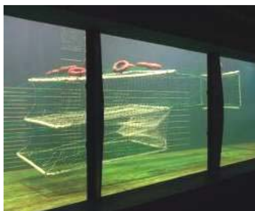
photo 15 : vue de l'arrière de la chambre haute avec cadre rectangulaire de maintien
