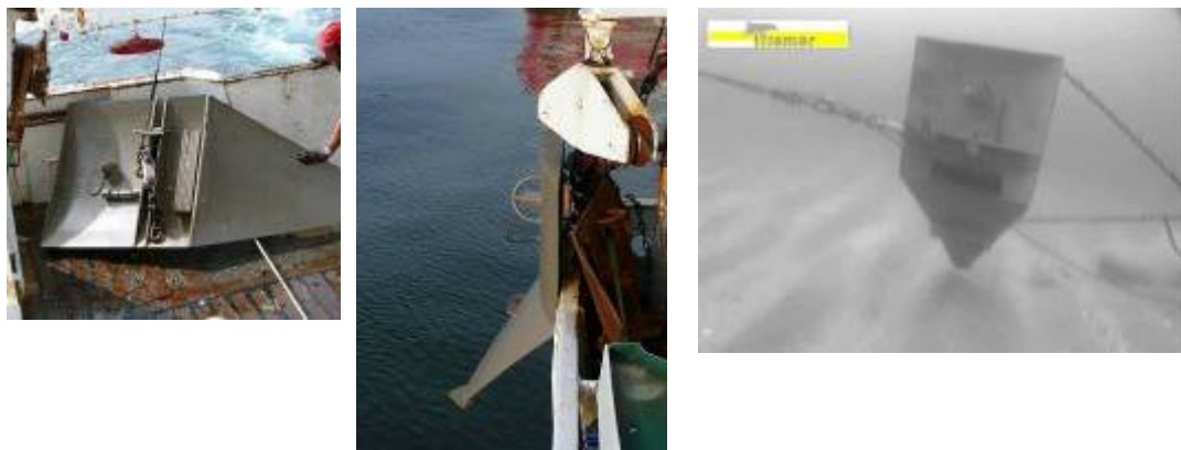
Photos 34-35-36 : Essais et vue sous-marine du panneau « jumper » à faible impact
