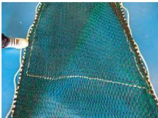
photo 10 : Le panneau à mailles carrées monté sur la face inférieure de la rallonge
