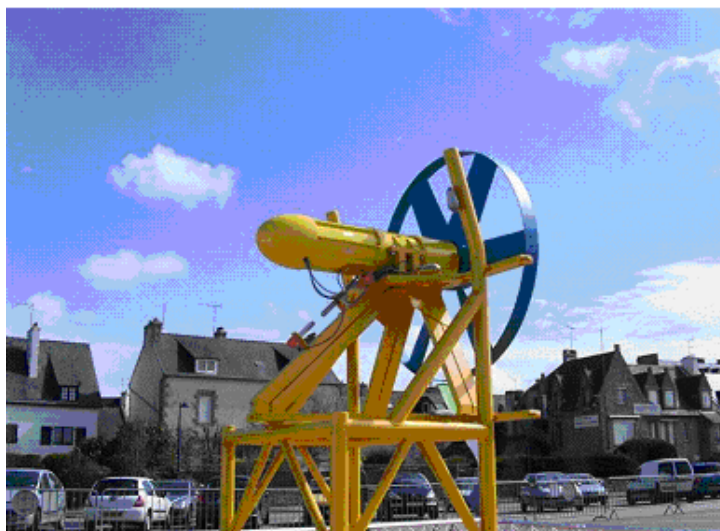
Photo 45 : prototype DO3 du projet SABELLA ® avant son immersion dans l'estuaire de l'Odet. (© Ifremer/G. VERON)
