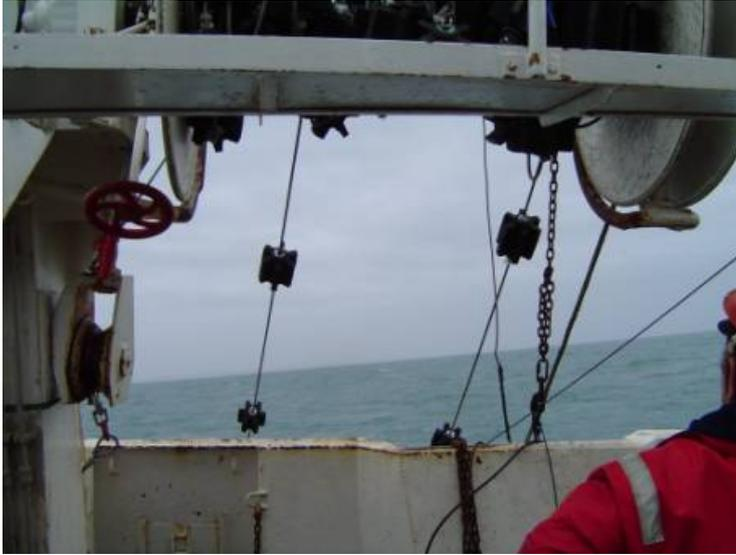
*Photo 19 : Tests sur le NO Gwen Drez de bras de chalut à faible impact (automne 2006).*
