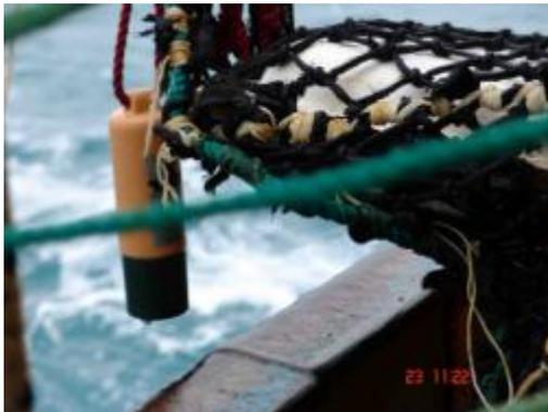
Photo 16 : Pinger commercial STM Products à l'arrière du netsonde
