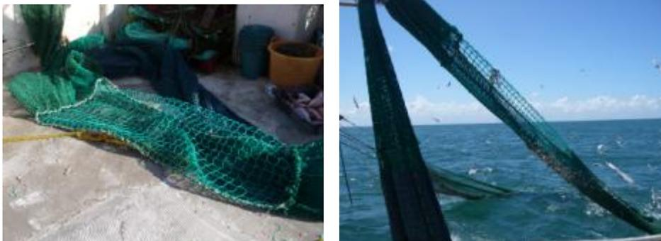
*Photo 6 : Panneaux de mailles carrées pour l'échappement des prises accessoires de poissons sur un chalut à crevettes guyanais.*
