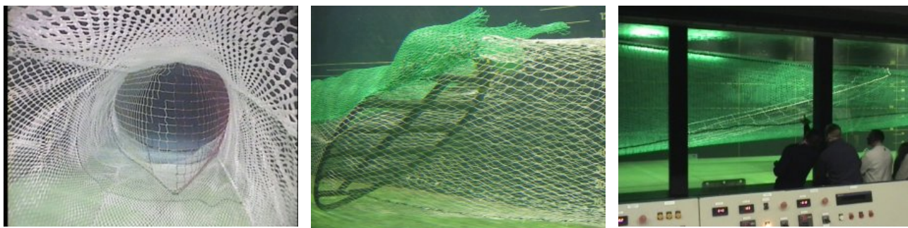
Photo 9 – Exemples de dispositifs d'échappement de cétacés testés au bassin de Boulogne
