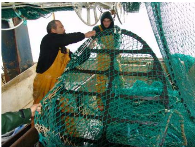
Photo 10 – Montage d'une grille semi-rigide « anti-dauphins » à bord du navire professionnel « Rochebonne ».
