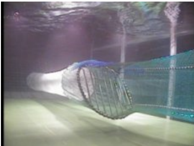
Photo 3 – Essai de TED au bassin de Boulogne sur mer
