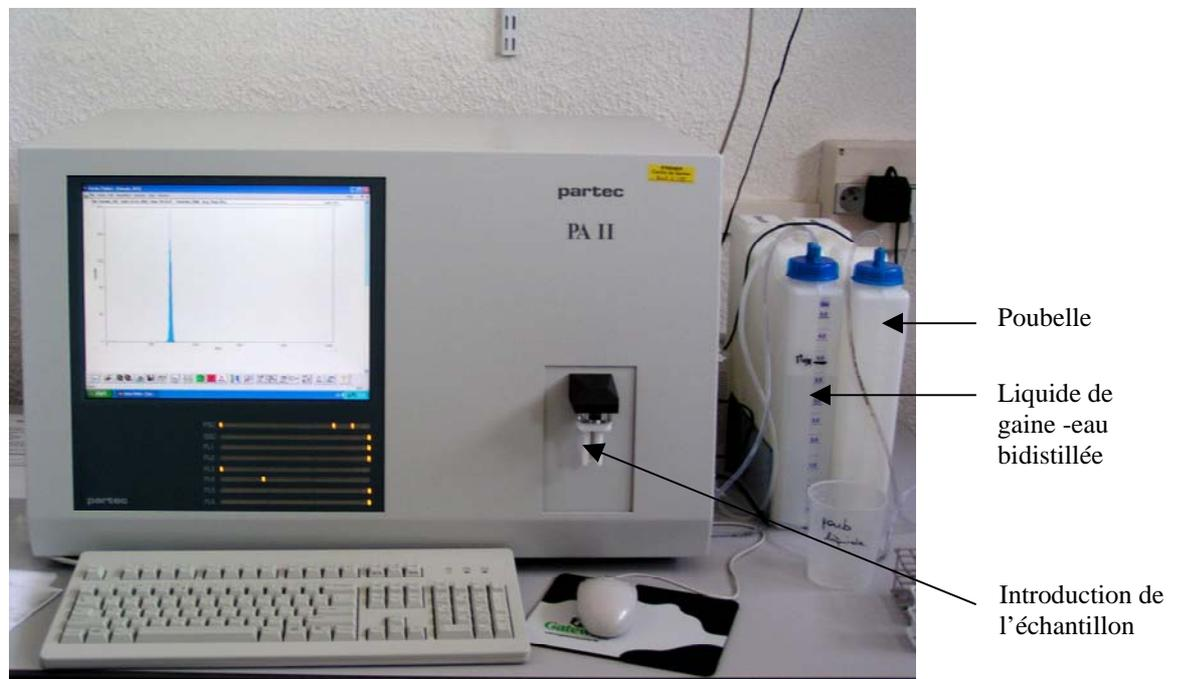
Figure 3 : Cytomètre en flux PARTEC PA II (M. Bonnard)
