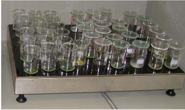
Figure 8 : Minéralisation de nos échantillons sur une plaque chauffante à 150°C
