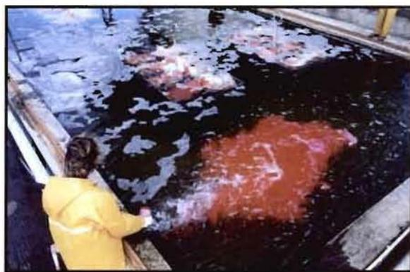
**Figure 8 :** Injection de rhodamine dans l'arrivée d'eau - T0 + 30 s (bassin avec coquillages)
