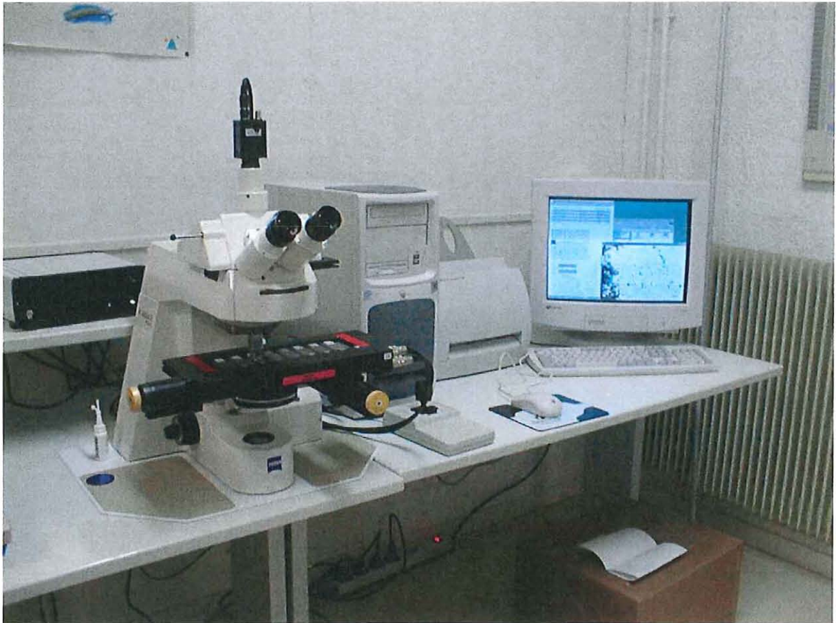
Figure 4. Système de recherche de métaphases automatisé
