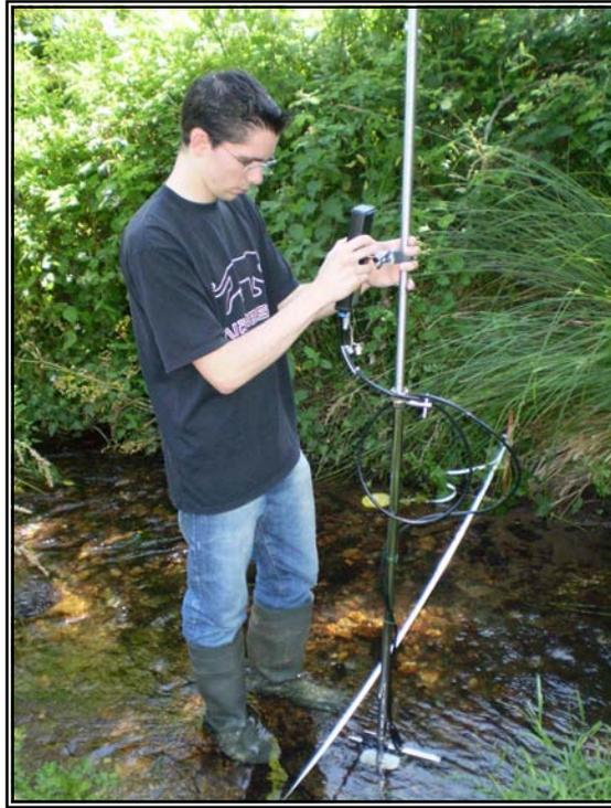
**Figure 8 : Mesure du débit à l'aide du courantomètre OTT ADC.**
