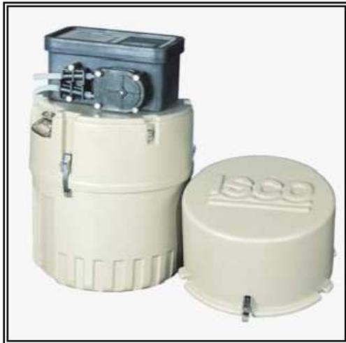
Figure 11 : Préleveur automatique de type ISCO
