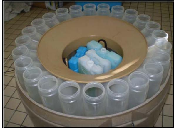
Figure 12 : Compartiments flacons avec réfrigérants, du préleveur automatique de type ISCO
