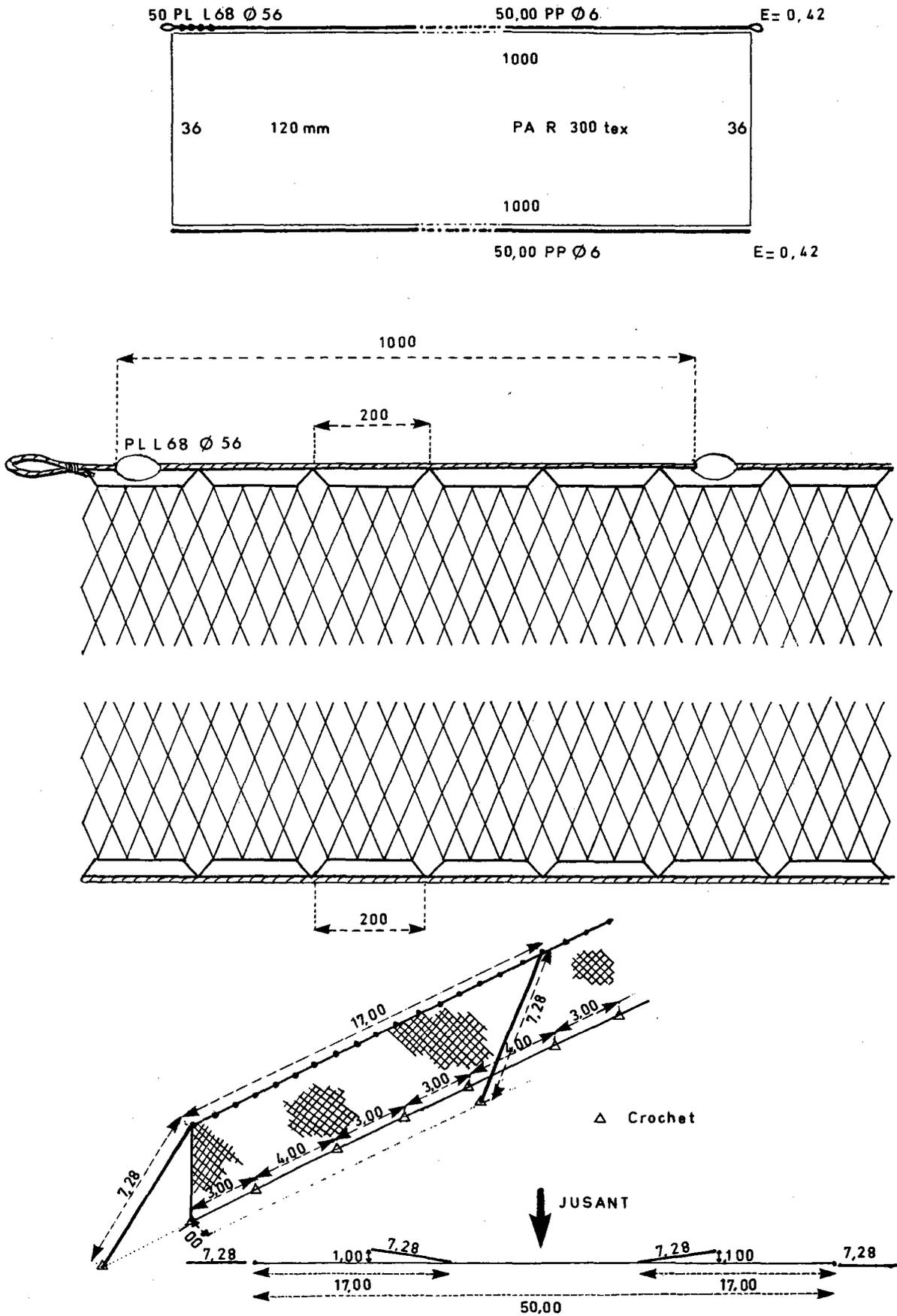
Fig. 5 - Filet maillant utilisé pour la capture de Salmonidés
