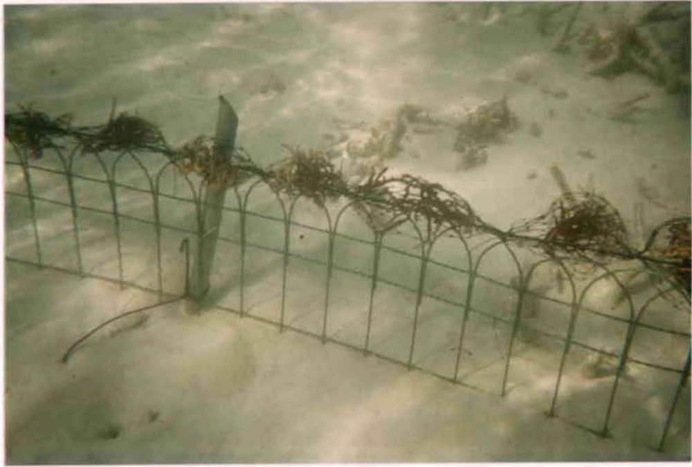
Photo 4.- Vue sous-marine du dispositif installé dans le lagon de l'île Tintamarre. Les piquets en fer sont enfoncés dans un mètre de sédiment.
