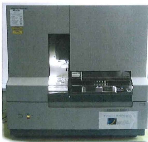
Figure 2. Séquenceur (Applied Biosystems 3130xl Genetic Analyzer®) utilisé en tant que génotypeur pour obtenir les tailles des allèles.
