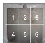
Figure 5 : Division en 6 zones de coloration (numérotées de 1 à 6) d'un biofilm actif formé sur un acier inoxydable en eau de mer naturelle (superficie: 25cm²)
