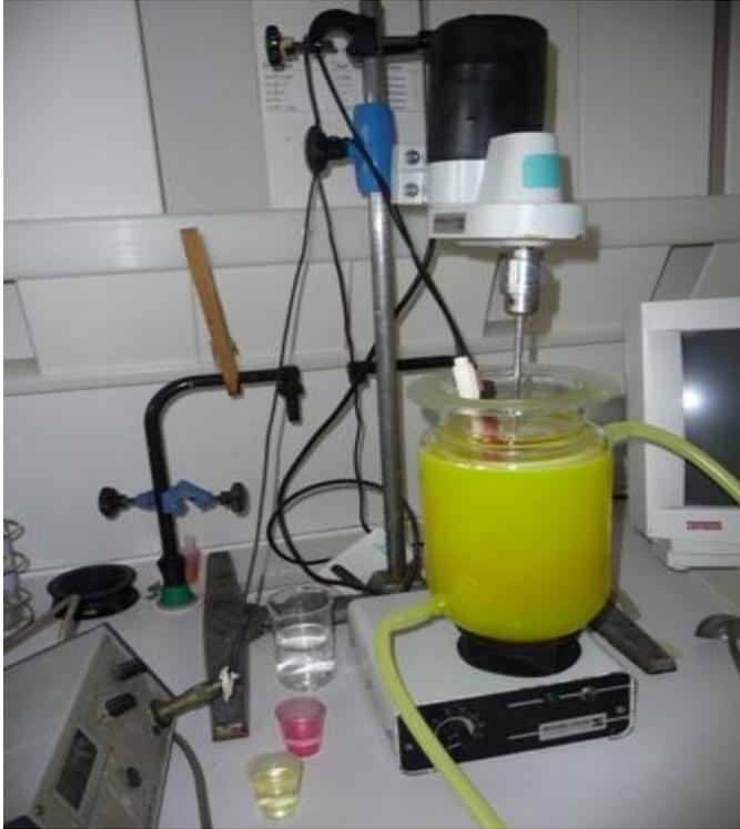
**Figure 6 : Bioréacteur à double enveloppes de laboratoire**
