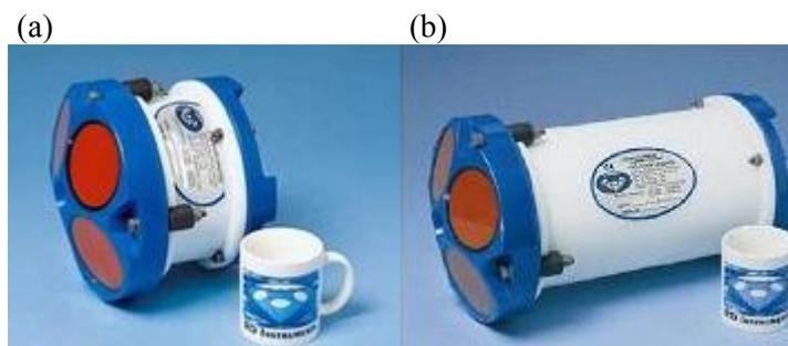
*Figure 4 : Présentations des deux 3D-ADCP, (a)°: le "monitor", et (b)°: le "sentinel" [RD Instruments, 2005].*
