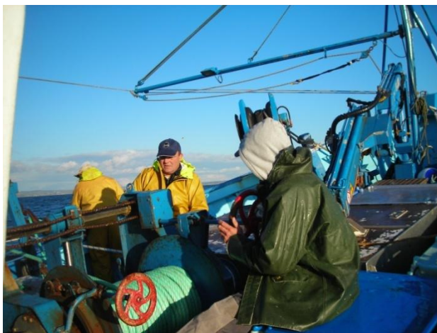
Photo n°7 : Virage de la coulisse au treuil
