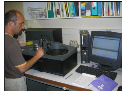
Fig IV.3.1 - le technicien principal Philippe Cann effectuant des mesures au granulomètre laser.
