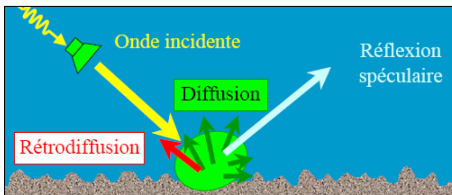
Fig III.1.3b - distinction entre réflexion, diffusion et rétrodiffusion.
