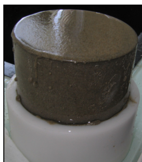
Sable fin 100 \mu\text{m} < D < 300 \mu\text{m} D_{50} = 192 \mu\text{m} Teneur en eau = 0,23
