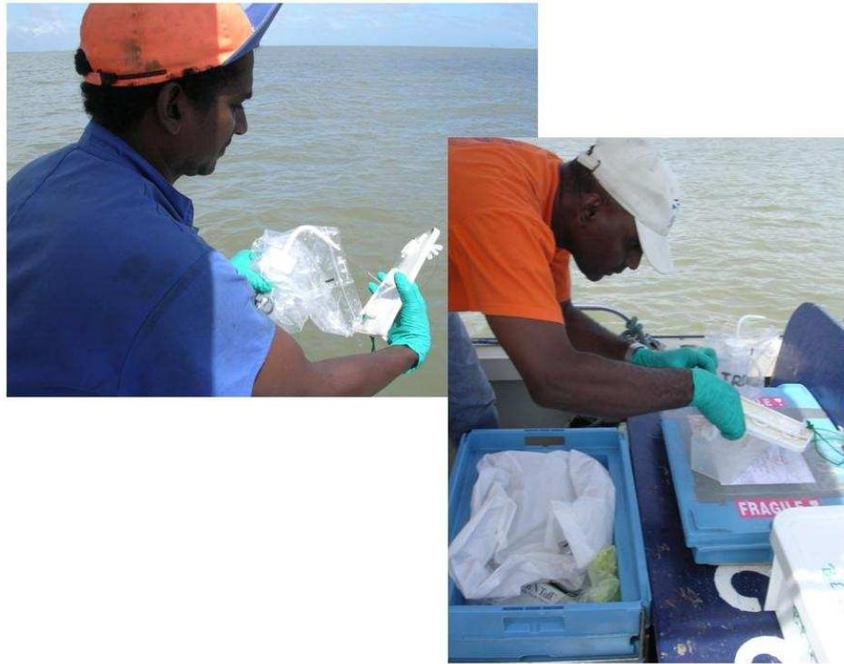
**Figure 8** : Récupération des DGT: rinçage et conditionnement avant retour au laboratoire.
