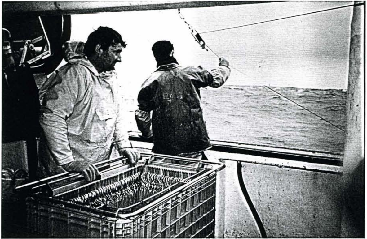
Cliché 13: Au virage, caisse prête à recevoir les avançons.
