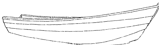
b. Canot créole guyanais en bois. La longueur varie entre 6 et 12 mètres pour une moyenne de 9 mètres.
