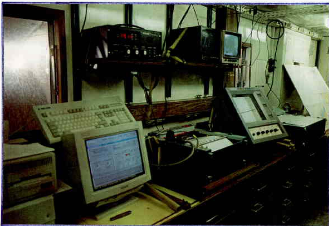
Fig.6 : Photographie des enregistreurs graphiques et du sondeur bathymétrique, lors de la mission PYLAR.
