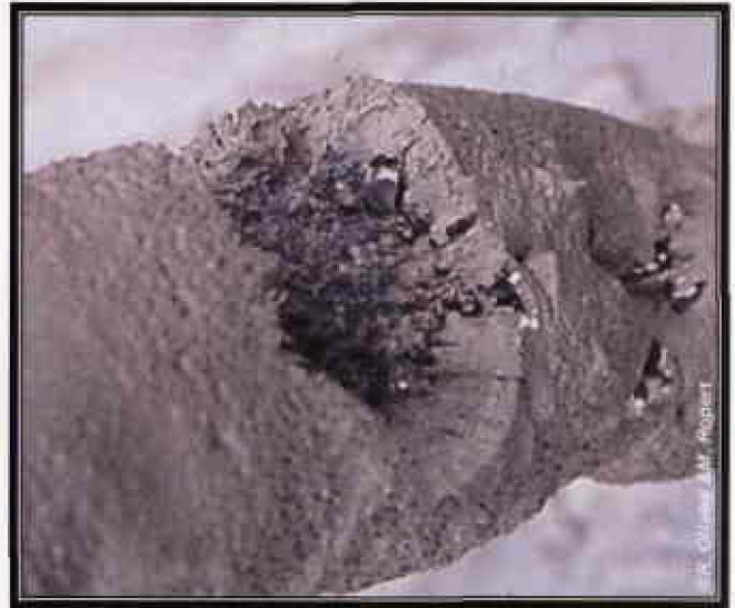
Photo 2: Vue en coupe de l'épaisseur du dépôt de "vase" sur une traverse de chantier à cordes
