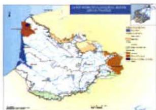
Présentation des différents aquifères constituant le sous-sol du Bassin Artois-Picardie. Un aquifère représente "une ou plusieurs couches souterraines de roches ou d'autres couches géologiques d'une porosité et d'une perméabilité suffisante pour permettre soit un courant significatif d'eau souterraine, soit le captage de quantités importantes d'eau souterraine".
