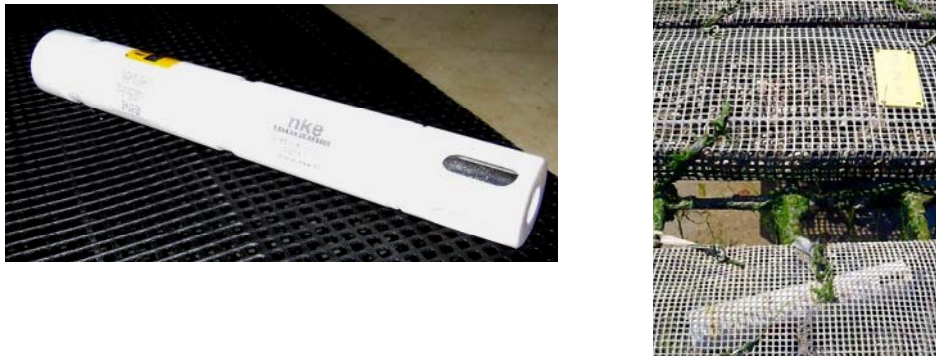
Figure 6 : Sondes d'enregistrement de type SP2T/STPS positionnées dans les poches ostréicoles
