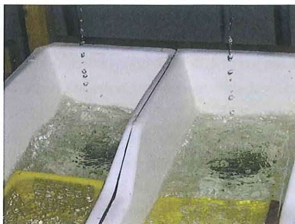
Figure 30. Turbulences engendrées par le système d'air-lift réglé à un débit de 40 l.min -1 .
