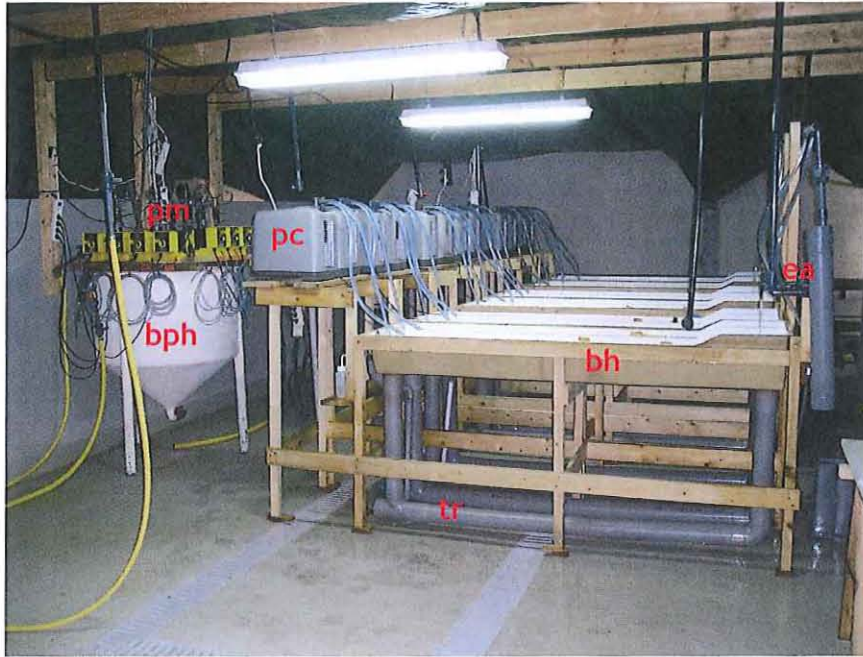
Figure 11. Vue générale des 12 systèmes re-circulés. ea : entrée d'eau dans le système re-circulé, bh : bac contenant les paniers d'huîtres, pc : pompe à chaleur assurant la thermorégulation de l'eau et équipée d'une lampe UV, pm : pompe à membranes apportant le phytoplancton au système re-circulé, bph : bac de stockage du phytoplancton tr : tuyau PVC assurant le retour de l'eau en début de bac.
