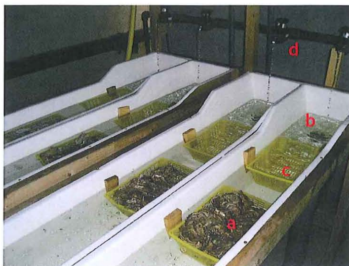
Figure 27. Dispositif de mesures de l'effet du courant sur les réponses physiologiques de 45 huîtres Crassostrea gigas disposées dans un panier (a). b : arrivée de l'eau mise en mouvement par l'air-lift ; c : panier vide placé pour limiter l'impact des turbulences dues à l'air-lift lors des mesures des vitesses de courant importantes. d : arrivée d'eau de mer de renouvellement.
