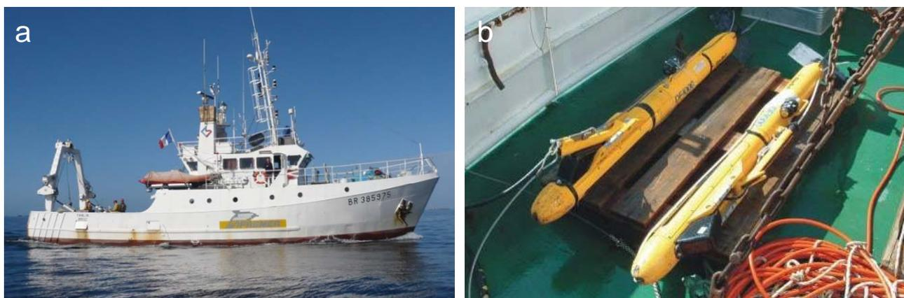
Figure 6. Le N/O THALIA (a) et le sonar à balayage latéral EDGETECH-DF1000<sup>®</sup> (b).
