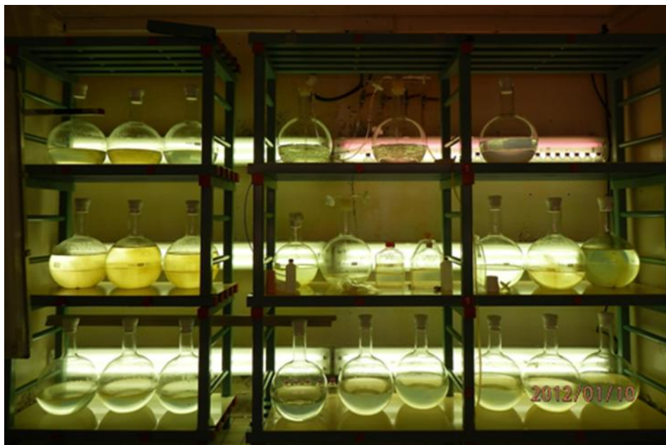
Figure 11. Cultures en batch (ballons de 10 L), à différents stades d'inoculum (volumes entre 3 et 8 L). Nota bene : les ballons du milieu gauche montrent les « anneaux » de dilution (les cellules s'accrochent toujours à la surface du ballon et à l'interface air/eau).
