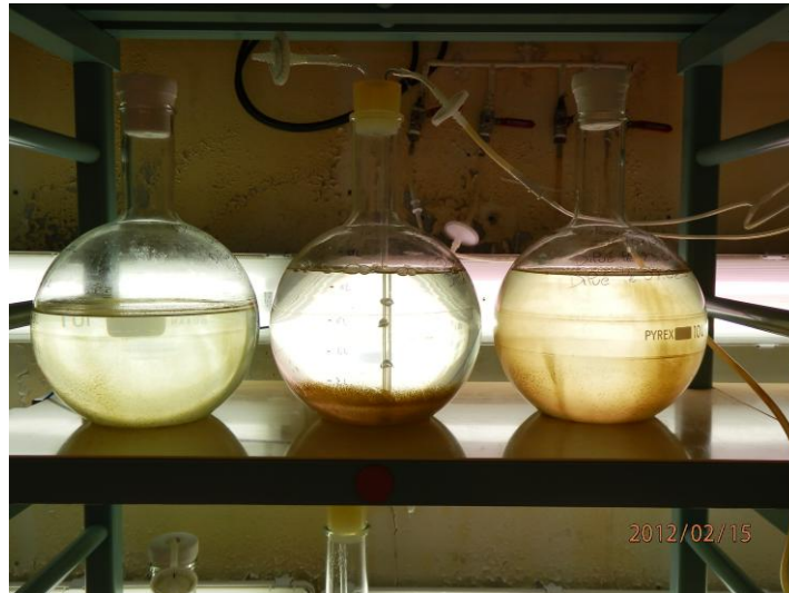
Photo 4 : Ballons des culture montrant les différents types de cultures testées : ballon avec urée (à gauche), ballon avec bullage (au centre) et ballon avec nitrates (à droite)
