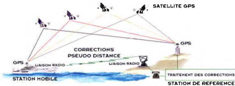
Figure 11 : Illustration du fonctionnement du GPS différentiel
