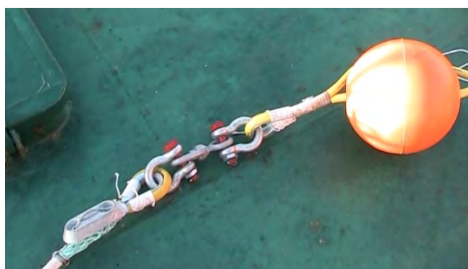
Mise en place des liaisons chapelet- orin principal mixte
