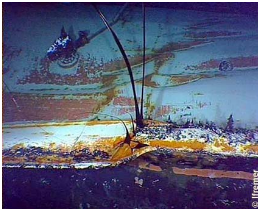
Fuite de fioul sur l'épave du Prestige
