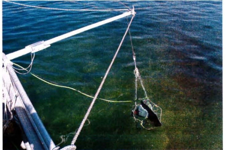
Figure 7 : mise en œuvre de la caméra remorquée.
