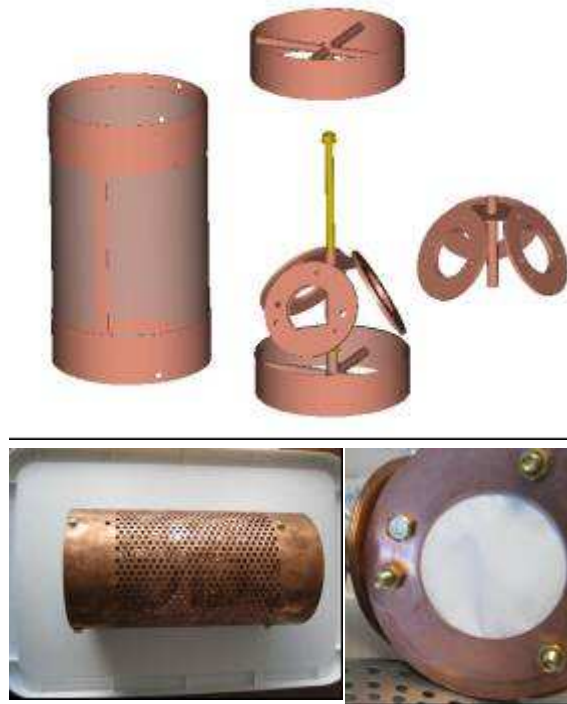
Figure 3: Schéma et photographie des cages, supports de disques et disques réalisés en cuivre
