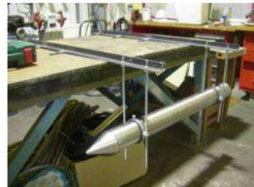
Photo 38: Piège à sédiment en acier inox
