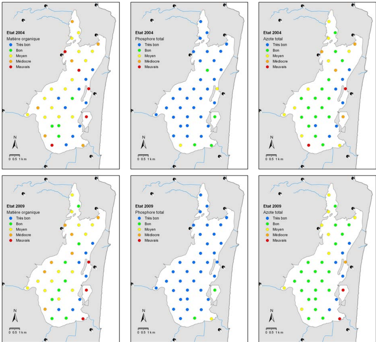
Figure 3. 8 Etats des sédiments vis-à-vis de l'eutrophisation pour la matière organique, le phosphore total et l'azote total en 2004 (en haut) et 2009 (en bas).
