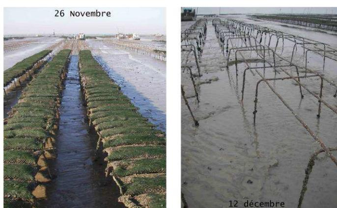
Fig.18 – Comparaison de l'aspect des sédiments de surface entre le 26/11/07 et le 12/12/07 sur le banc de Lamouroux. : (à gauche) le 26/11/07, le sédiment est une vase très fluide, d'épaisseur pluricentimétrique ; (à droite) le 12/12/07, le sédiment de surface est sablo-vaseux à sableux. Des figures d'érosion de plusieurs mètres carrés sont visibles, ainsi que des rides de clapots [Kervella, 2009]
