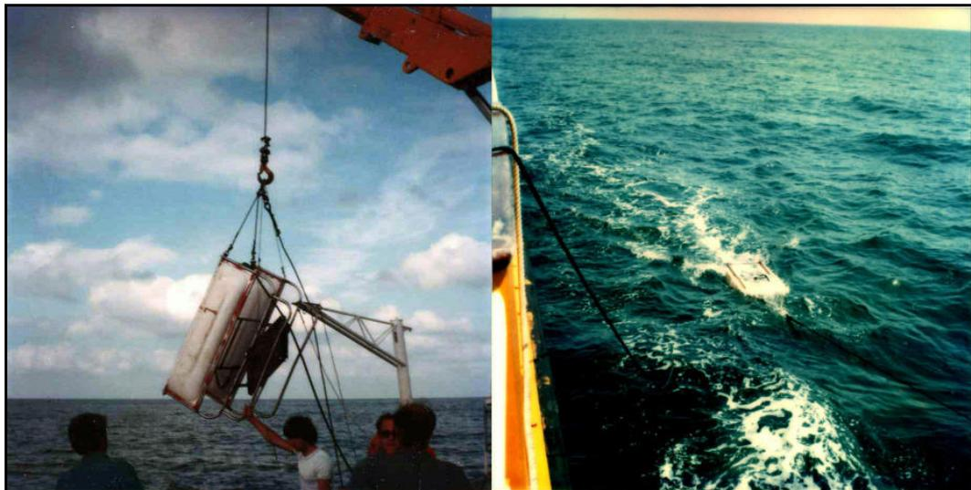
Figure 1-4 : Système Boomer (mise à l'eau et remorquage).
