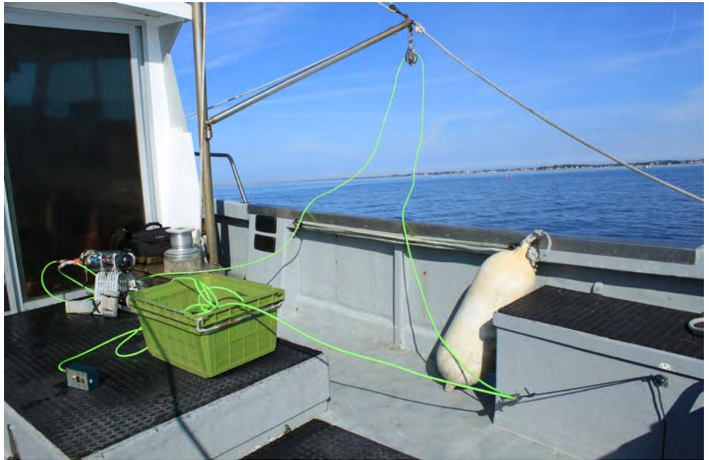
Illustration 28 : système de poulies permettant de tracter la caméra et de régler sa hauteur en fonction de la nature du fond, de la vitesse du bateau et de la visibilité
