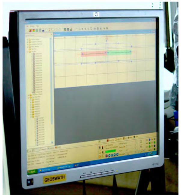
Illustration 18 : écran de contrôle du sonar interférométrique geoswath
