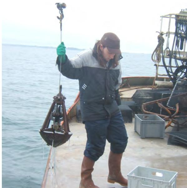
Illustration 15 : prélèvements de sédiments grâce à une benne "orange peel"
