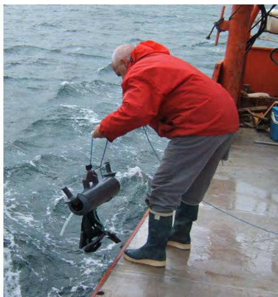
Illustration 14 : prélèvement d'eau grâce à une bouteille Niskin
