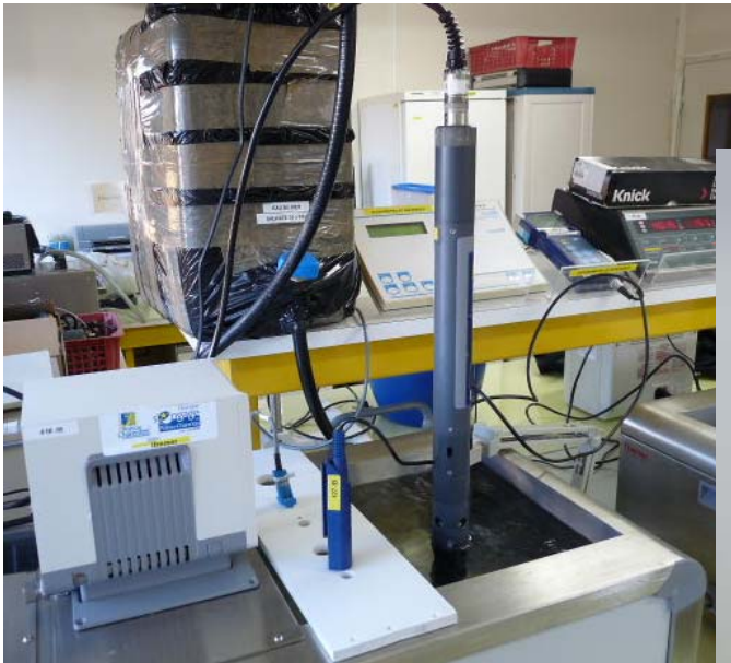
Etalonnage de la sonde Ysi sur le Banc d'étalonnage
