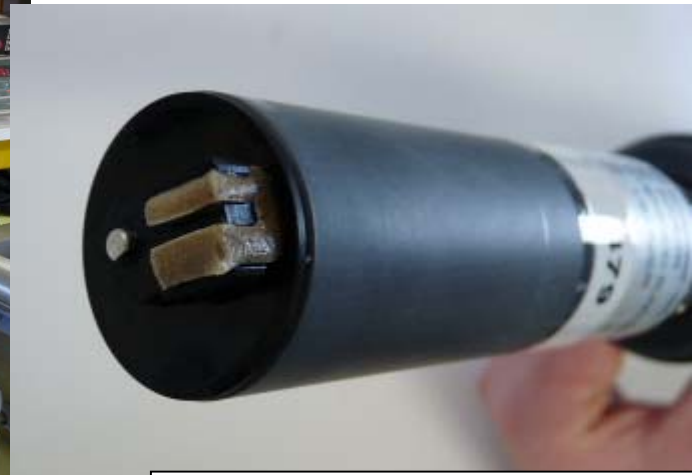
Capteur optique de turbidité à 4000 FNU avec patin
